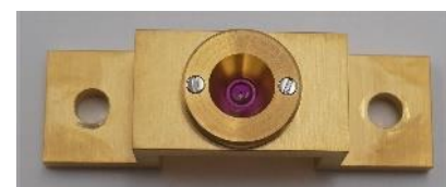
Ankerbrücke einer Präzisionspendeluhr.
