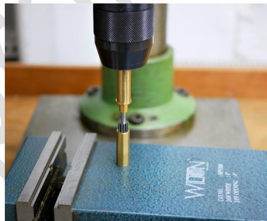
Aufpressen des Radträgerflansches auf die Welle. Als Presse fungiert hier eine Tischbohrmaschine.
