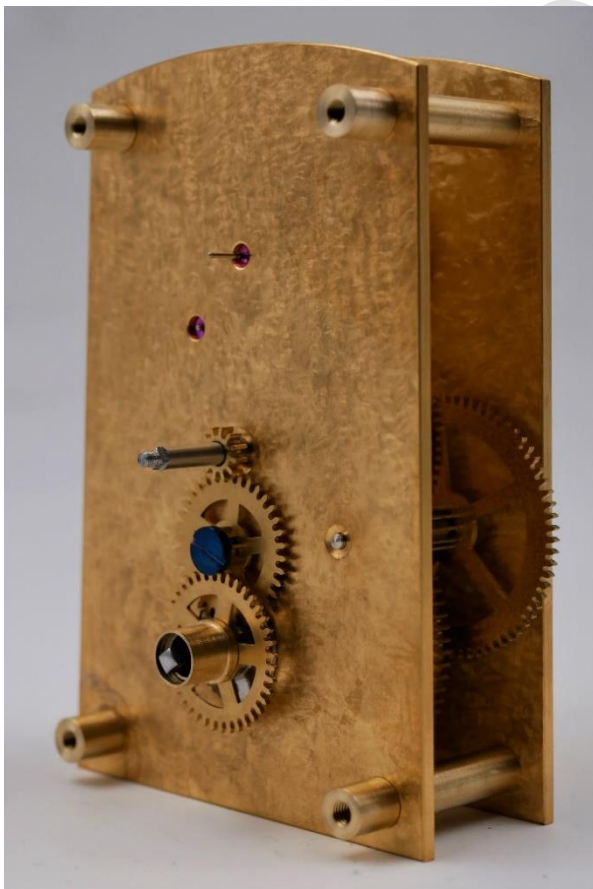
Uhrwerk mit fertigen, entgrateten und finiszierten Platinen.
