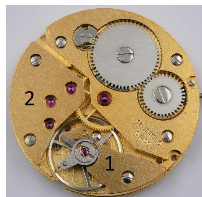
Taschenuhrwerk mit (Unruh-) Kloben (1) und (Räderwerks-) Brücke (2).
