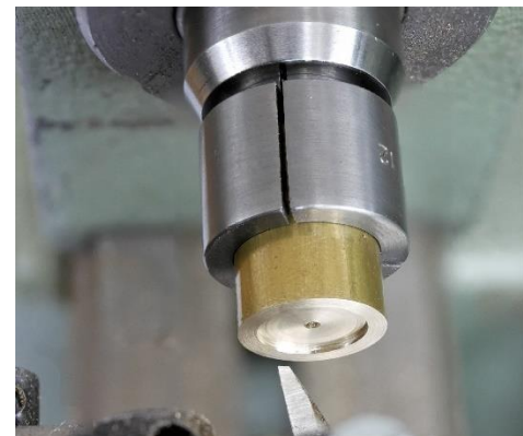
Ausdrehung passend zum Raddurchmesser.
