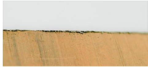
Durch das Feilen der Fase aufgeworfener Grat.
