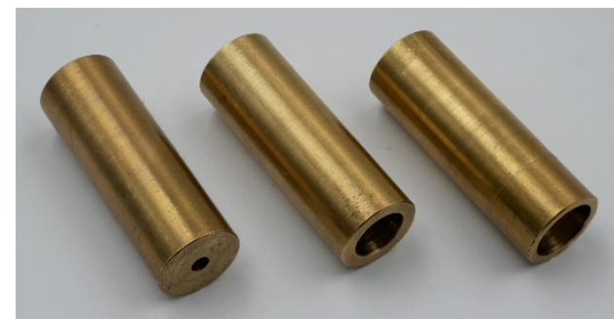
Damit beim Aufpressen keine Macken am Werkstück entstehen, verwendet man Messingstücke als Presswerkzeug. Diese kann man leicht in verschiedenen Durchmessern selbst herstellen.
