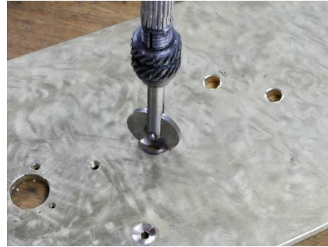
Entgraten mit einem Rollsenker.
